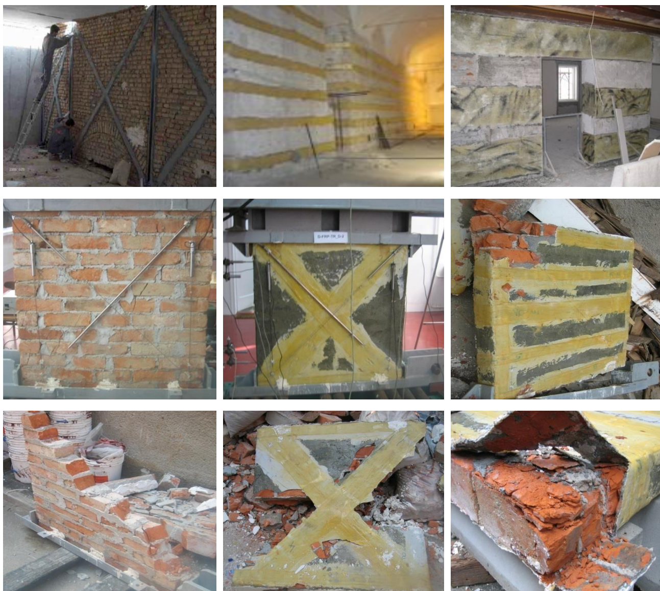
Slika 2.83 Primjeri pojačanja lamelama i trakama te njihova ispitivanja
