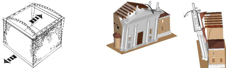
Slika 2.54 Povezivanje zidova za osiguranje nerazdvajanja visokih zidova [5]
