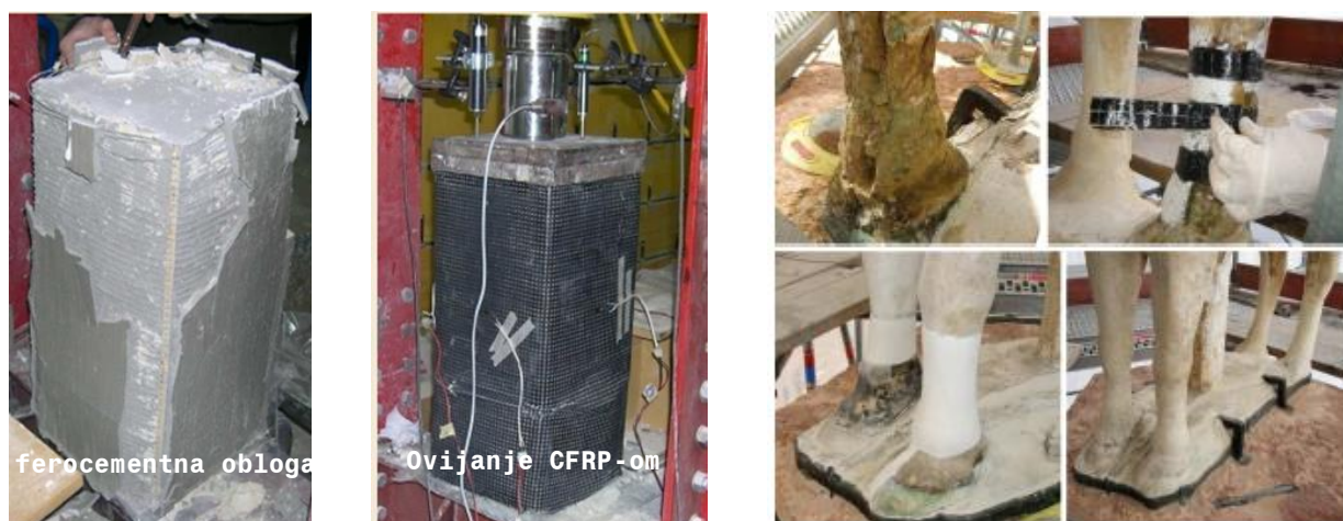
Slika 2.40 Primjer pojačanja stupova fero cementnom oblogom, CFRP-om i prikaz sanacije kiparskih elemenata
