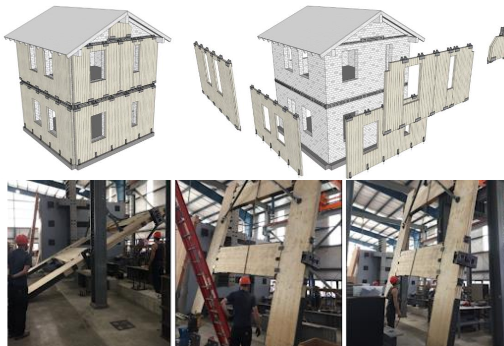
Slika 2.69 Pojačanje neomeđenog zida CLT-om [6]
