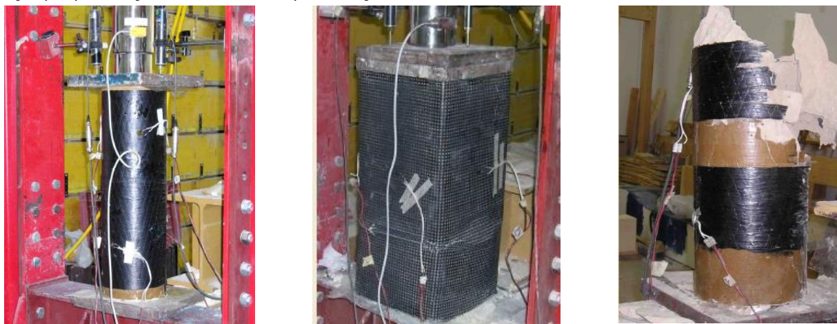
Slika 2.84 Primjeri ispitivanja ovijenih stupova
