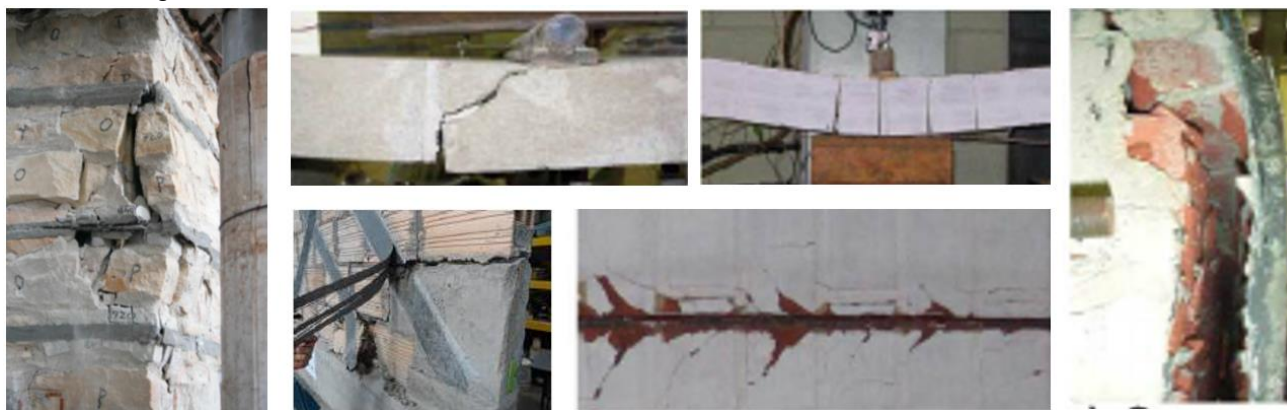
Slika 2.5 Načini otkazivanja ziđa pojačanog FRP-om [2]
