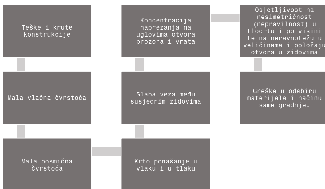
Slika 1.2 Prikaz glavnih nedostataka i razloga otkazivanja neomeđenog ziđa
